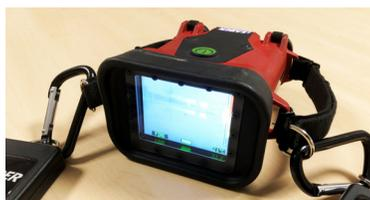
Le SDIS s'est doté de **31 nouvelles caméras thermiques**, d'un montant unitaire de 3 500 €, dans tous les engins du département de lutte contre les feux urbains. D'un point de vue opérationnel, la caméra pourra être utilisée pour rechercher des victimes dans des lieux enfumés ou sombres, pour localiser un foyer d'incendie, des foyers résiduels, des feux couvant et afin de faciliter les cheminements et la recherche d'itinéraires de repli.
